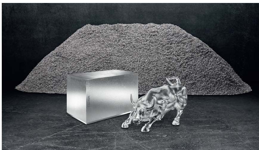
1 Bulle Fritz: Aus einem Aluminiumblock wurde das Schauwerkstück auf einem 5-Achs-BAZ des Typs C 650 herausgearbeitet – ein Spänevolumen von 3,5 m 3 innerhalb 35 Stunden Laufzeit (© Hermle)
